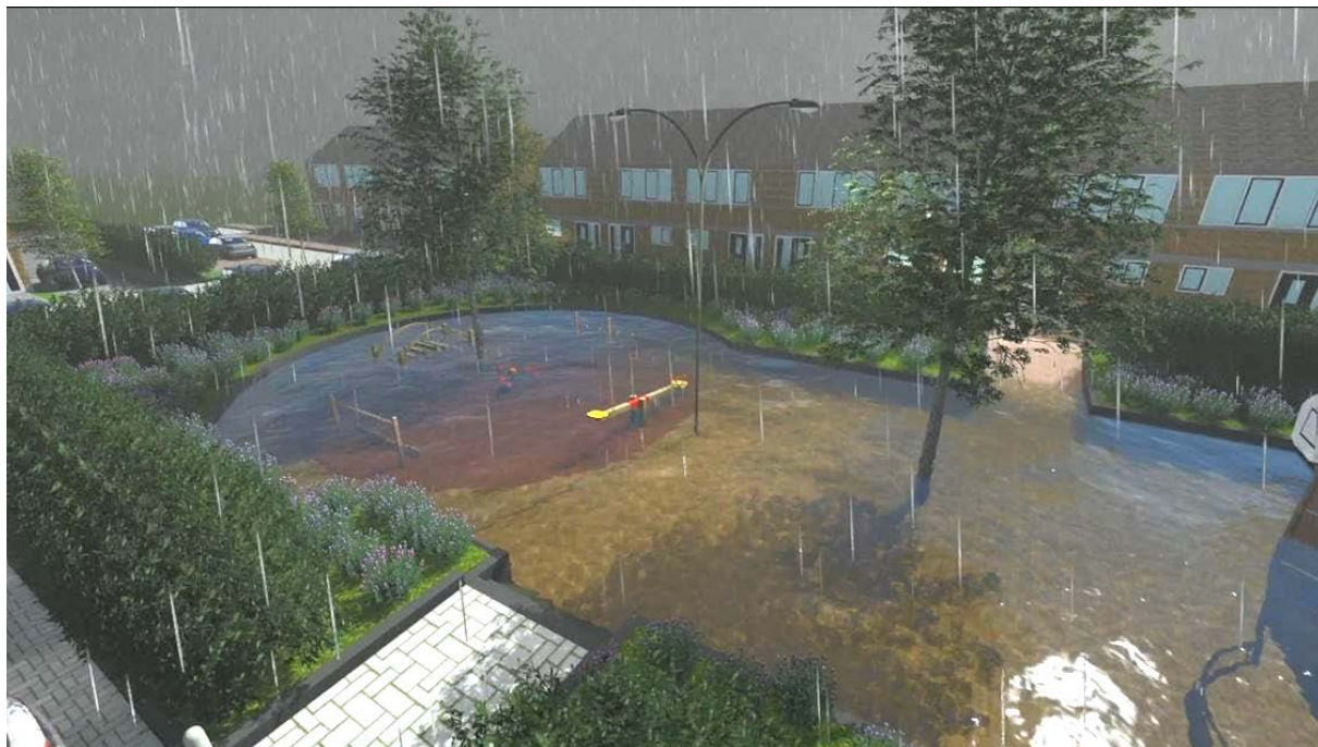
Figuur 2.2 Ontwerp van een verdiept aangelegde speelplaats waar hemelwater geborgen wordt (Vlindertuin, minor HvA)
